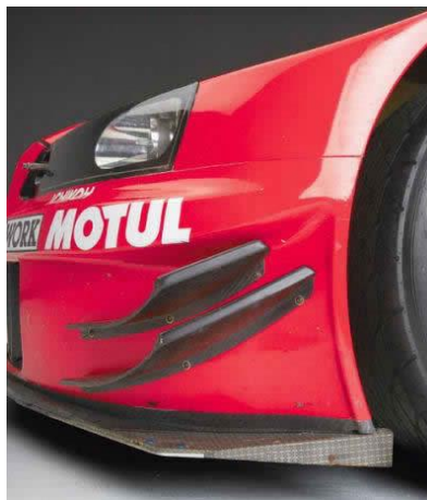
Слика 2: закрилца на боку браника тркачког возила
