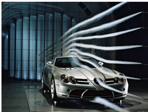
Слика 1: Струјање дима у ваздушном тунелу око возила (Mercedes Benz SLR McLaren)
